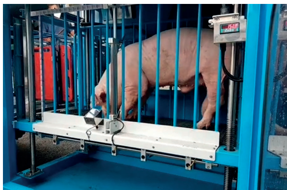
❖ 3D豬隻體型量測機，單人操作完全自動化。
