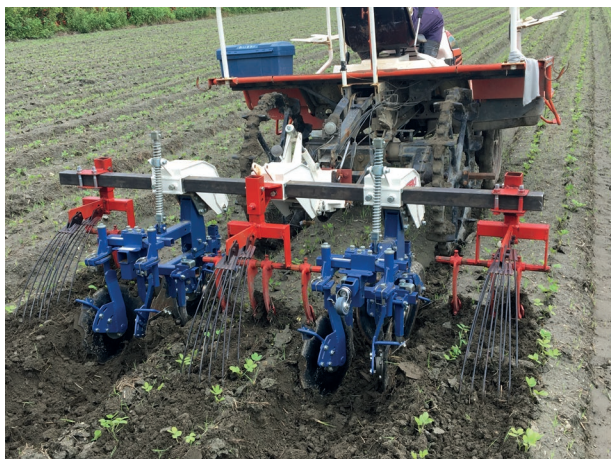
❖ 在地化除草機開發過程與農友合作田間測試，配合旱田環境採用不同機械套件。
