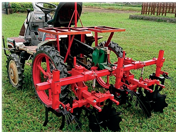
❖ 在地化除草機開發過程與農友合作田間測試，配合旱田環境採用不同機械套件。
