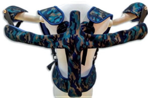
❖ 穿戴上臂省力機具（左圖）進行葡萄疏果作業（右圖）。
