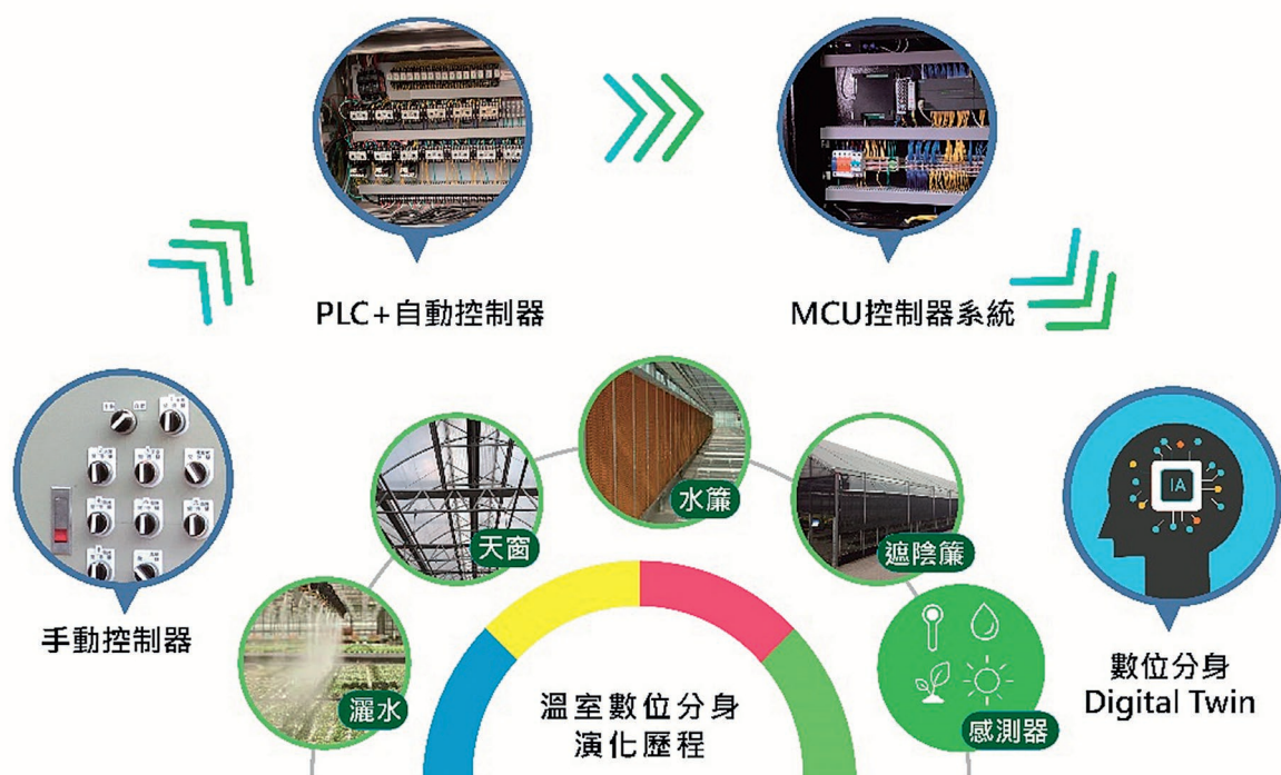
❖ 溫室之環控設備及傳統型至智慧型之控制器演化歷程。
