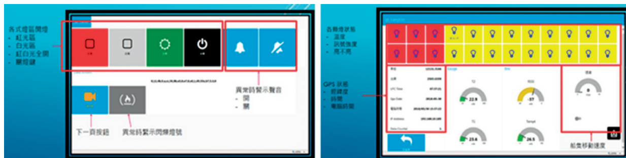
❖ 秋刀魚漁業集魚燈具控制系統面板。
