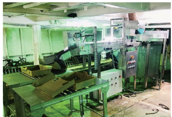
❖ 秋刀魚排整與裝箱輔助系統在船艙安裝作業情況。
