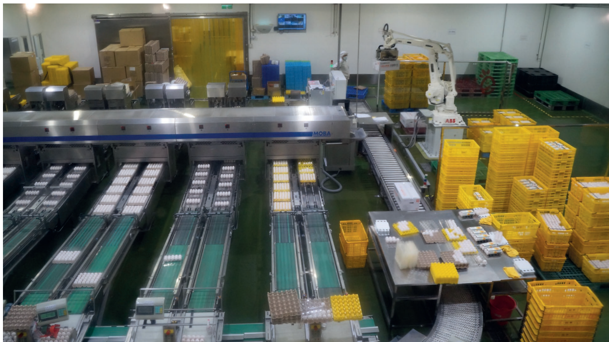
✦ 雞蛋彈性搬運系統用機械手臂取代人工搬運，包裝廠員工不再腰痠背痛。
