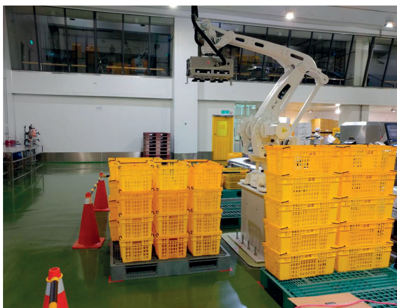
❖ 彈性搬運系統系統利用RFID跟QR Code協助機械手臂辨識，準確把不同規格的雞蛋搬到相對應棧板位置。
