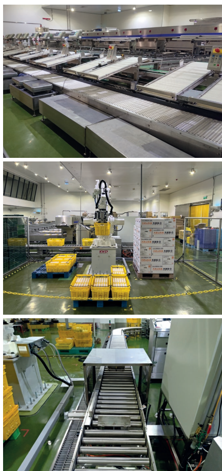
❖ 彈性搬運系統系統利用RFID跟QR Code協助機械手臂辨識，準確把不同規格的雞蛋搬到相對應棧板位置。
