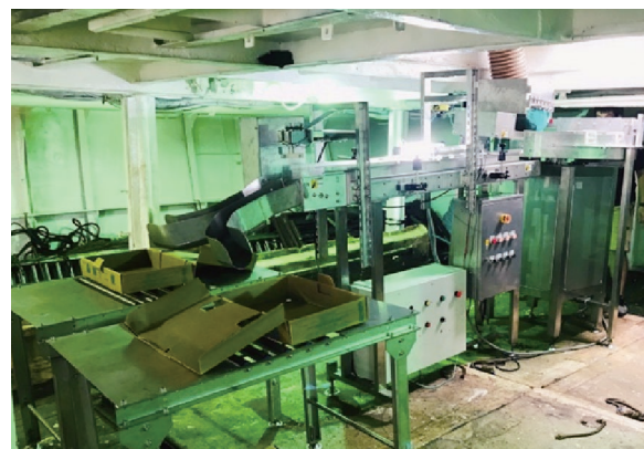
❖ 秋刀魚排整與裝箱輔助系統在船艙安裝作業情況。
