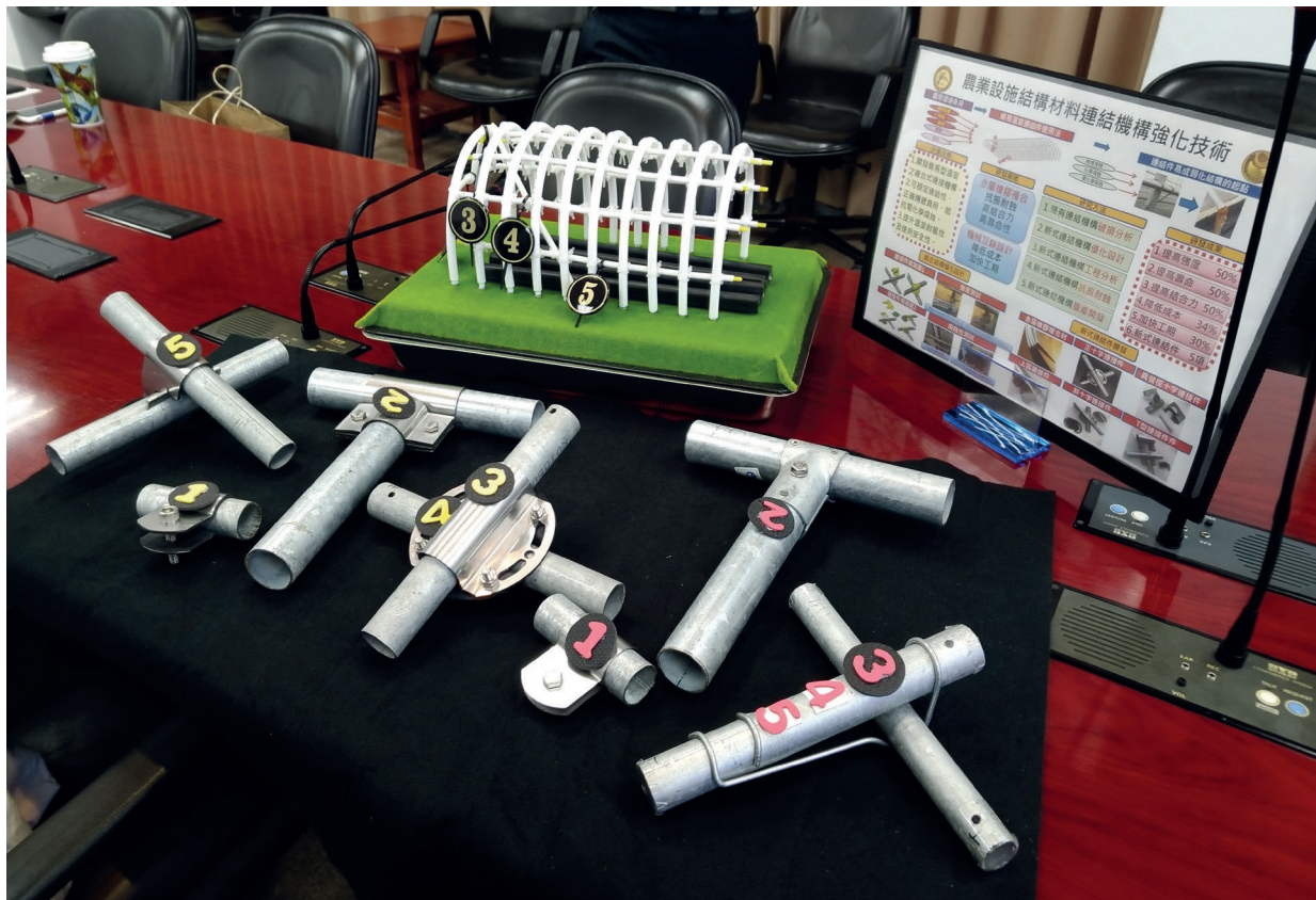
✦ 簡易型溫室複合式連接機構。
