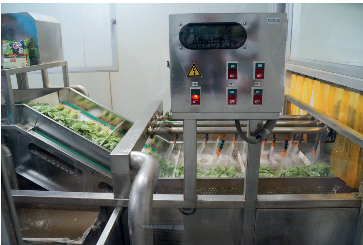
❖ 桃城蒔菜集貨場利用水冷清洗系統維持蔬菜採收後最佳鮮度。
