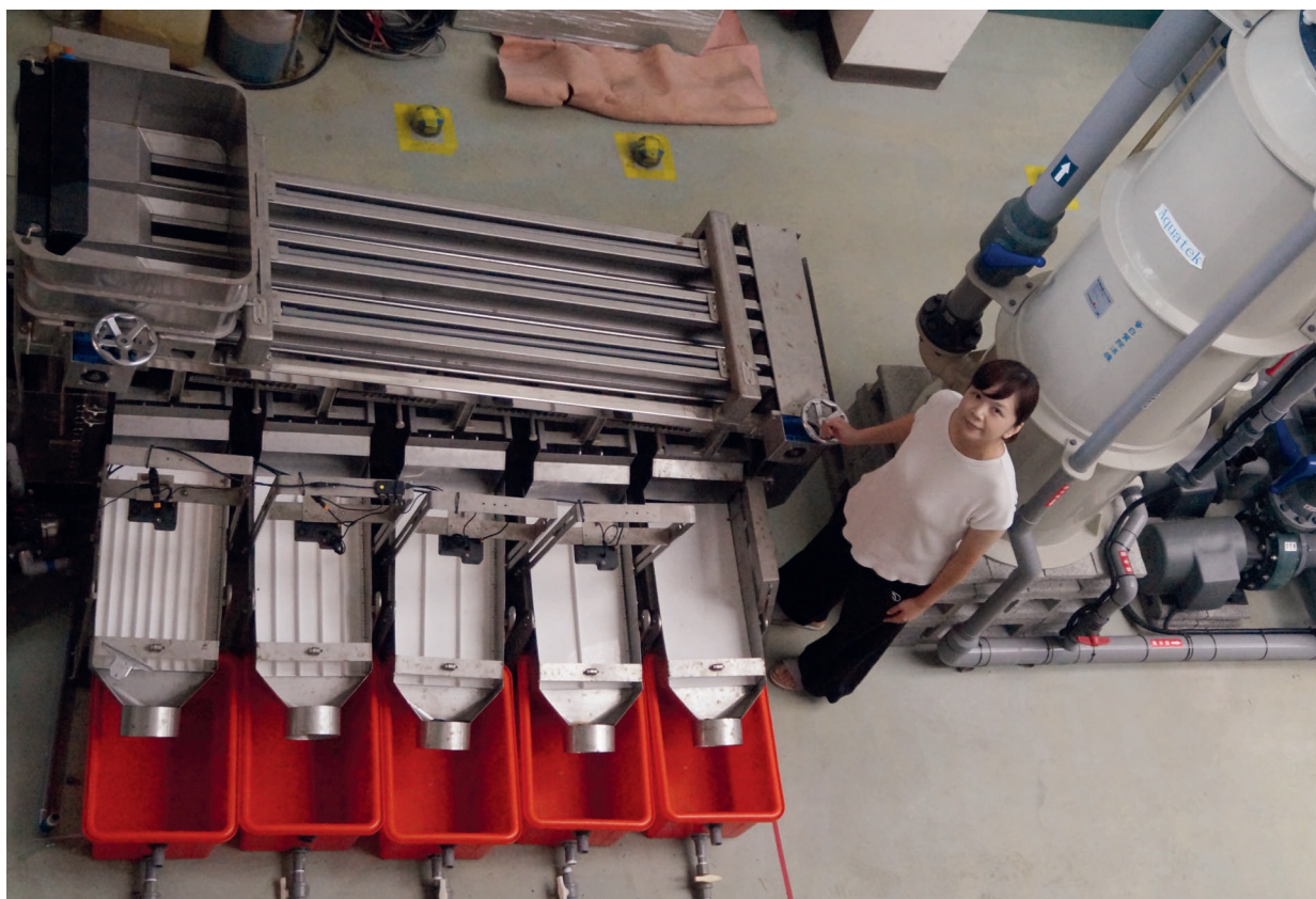
❖ 精準且迅速的魚苗智能分級篩選機是峰漁邁向智慧農業的初體驗。
