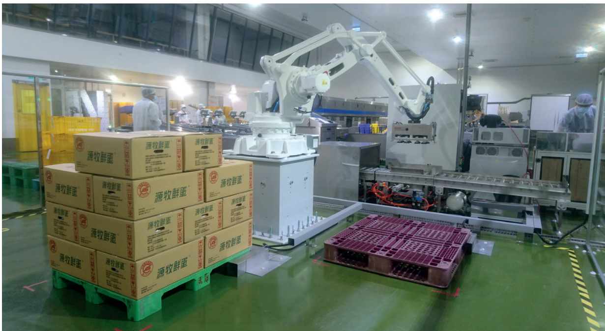
❖ 「雞蛋彈性搬運系統」利用機械手臂自動把蛋箱抓取到指定棧板堆疊。
