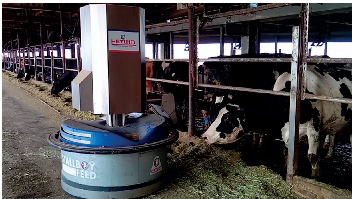
❖ 推草料暨餵精料機器人有2個精料桶，各可裝填70公升精料，透過香氣吸引牛隻前來吃草。
