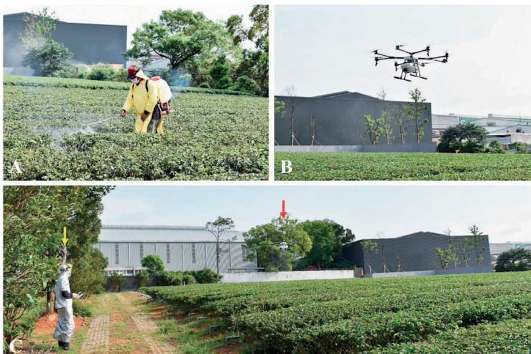
❖ 相對於傳統施藥使操作者暴露於農藥中（圖A），應用無人機管理茶園病蟲害，定速、定高與定流量施用藥劑（圖B），降低操作人員農藥暴露風險。
